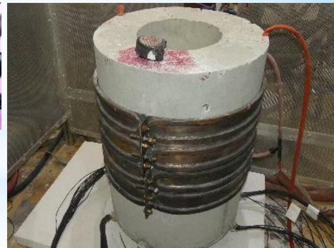
Creuset en béton équipé + boucle inductive
