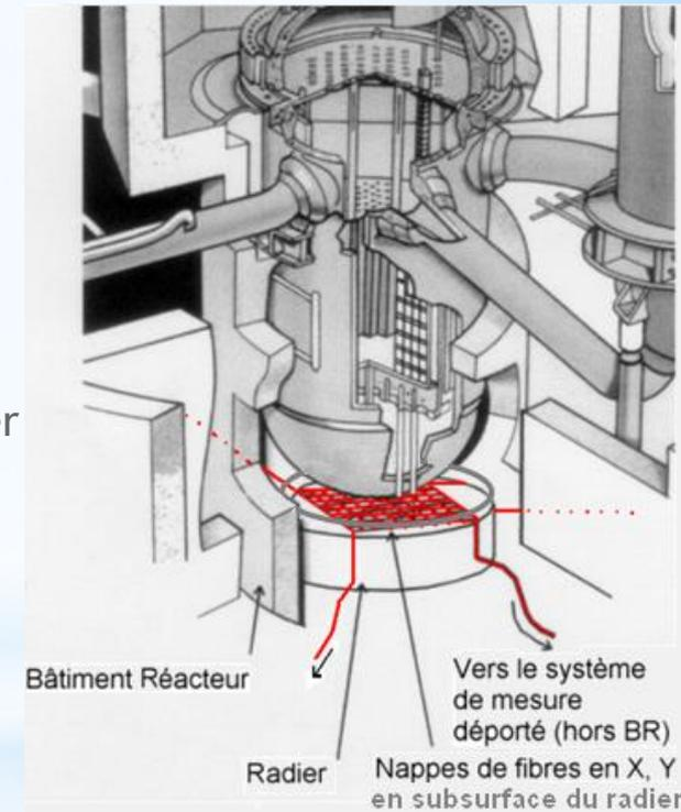
**Résultats** : Infos temps réel sur : le percement de la cuve, l'avancée du corium, l'état du radier, sa température + l'intégrité de la sous-couche réfractaire de zircone + cinétique de refroidissement du corium
