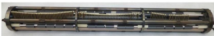
Figure 2.1 : Porte-échantillons du four de pré-oxydation.
