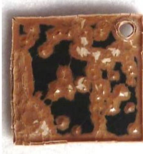
Figure C.1 : Photographie d'échantillon vierge oxydé sous air à 850 °C, pendant 4h15. Montée en température et isotherme sous air.
