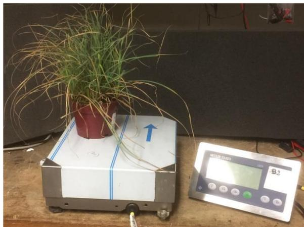
Figure 3.5 - Balance de précision et afficheur
