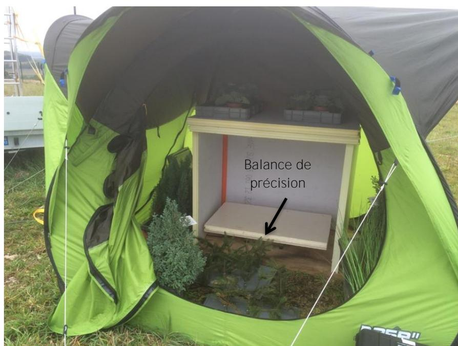
Figure 3.12 - Tente dans laquelle sont placées la balance de précision et la chambre de protection représentée ici avec le panneau avant enlevé permettant ainsi de déposer le bac à peser sur le plateau de la balance situé sous la plaque de polystyrène en partie basse.
