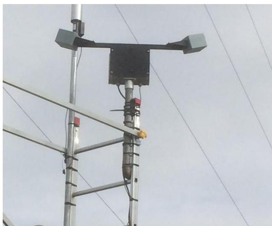
Figure 3.2 - Visibilimètre installé sur site d'Houdelaincourt.
